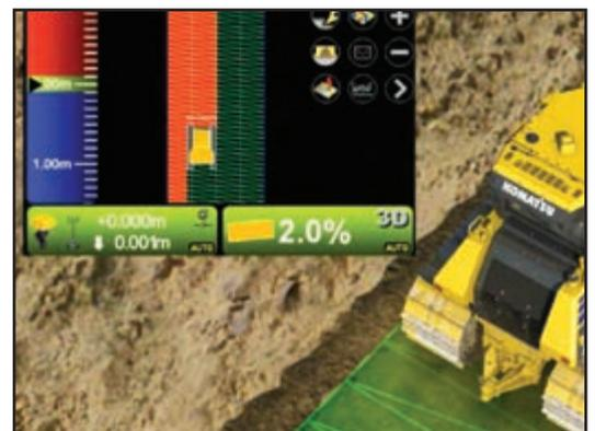
Enregistrement de la surface en temps réel: L'antenne GNSS sur le toit de la cabine permet de collecter les données relatives à la surface en temps réel en mesurant les altitudes précises à mesure que l'engin continue de travailler.
