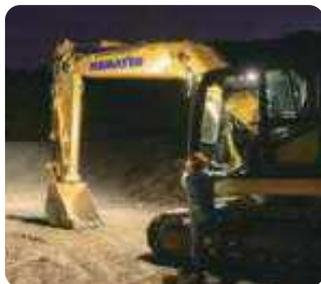
déverrouille la portière de la cabine, l'éclairage LED s'allumera et l'opérateur pourra monter en toute sécurité.
